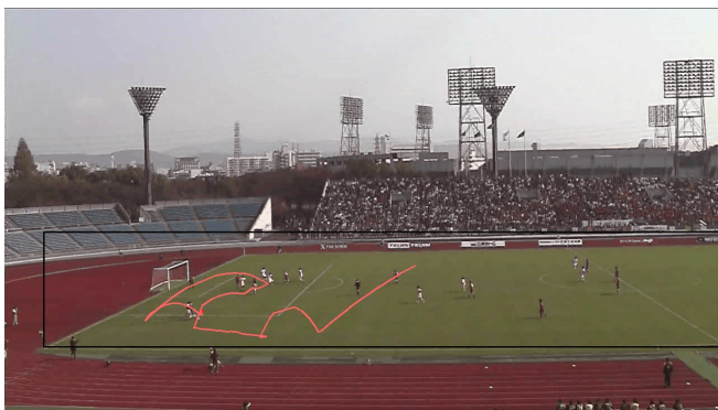
図 7 ボールの追跡結果の例：パーティクルフィルタ（追跡開始から 300 フレーム分）
