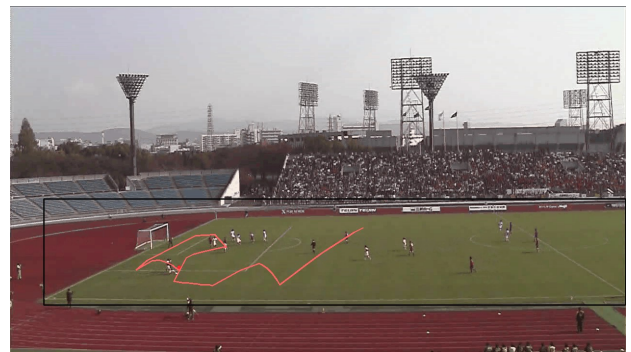
図5 ボールの追跡結果の例：正規化相互相関法(追跡開始から300フレーム分)
